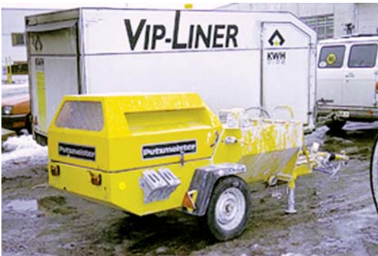
Оборудование для заливки межтрубного пространства.
